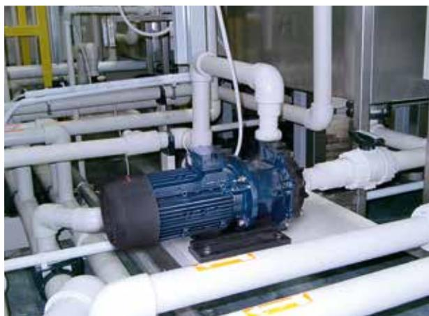
MAGSON BG 5 zur Umwälzung eines Galvanikbades mit Schwefelsäure über einen Wärmetauscher zur Temperaturhaltung.
