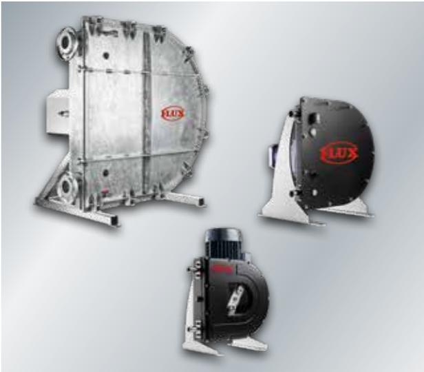
Die PERIPOWER Schlauchpumpe ist eine starke selbstansaugende Verdrängerpumpe, die mit ihrer extremen Robustheit und einfachen Wartung überzeugt. Die Funktionsweise ermöglicht eine schonende Förderung von abrasiven Medien und ist ideal konzipiert, um Medien mit einer Viskosität von bis zu 20.000 mPas, einer Trockensubstanz von 25 %, sowie Partikeln mit einer Größe von bis zu 40 % des Schlauchdurchmessers effizient zu fördern.
