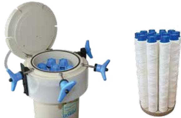
SONCO Filter z.B. als Kerzenfilter zum Filtern eines Nickel-elektrolytbades
